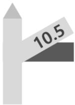
L'inclinaison de la voie est signalée par des panneaux de ce type, sur le côté du rail.
