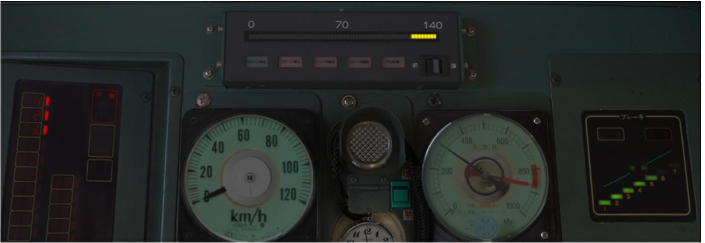
A gauche de la console, nous avons le numéro des voitures et le statut d'ouverture des portes (indicateur rouge = portes ouvertes).
