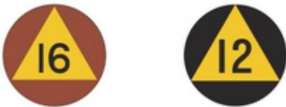
Lorsque l'on rencontre ce panneau, il faut valider, via un pointage-et-appel, le prochain signal visible. Ce panneau peut contenir un indicateur spécifiant la nature du prochain signal :
