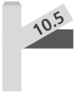
L'inclinaison de la voie est signalée par des panneaux de ce type, sur le côté du rail.
