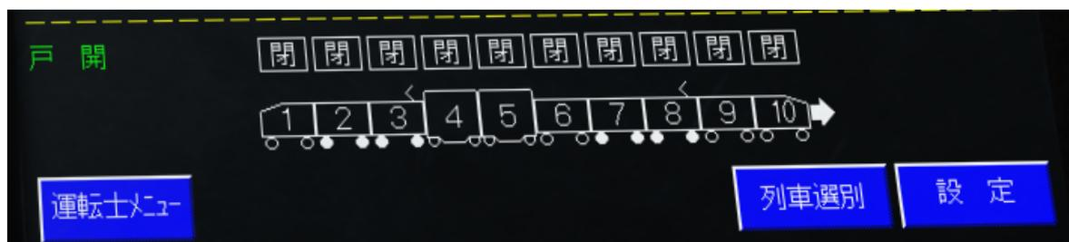
Dans cette zone (si présente) est représenté les différentes voitures. L'indicateur au dessus de chaque voiture (□ ) indique si les portes sont ouvertes (allumé) ou non. Les voitures peuvent prendre 2 couleurs : bleu (les moteurs sont utilisés) ou jaune (les freins sont utilisés).
