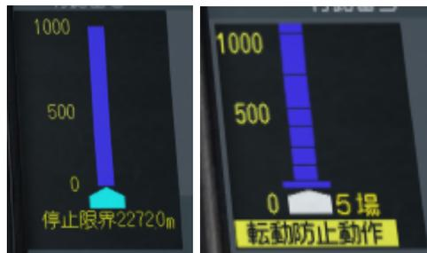
Dans les trains disposant de la fonctionnalité, la partie gauche représente le kilomètre à venir. Chaque bloc bleu représente une section de la voie. Les gares sont représentées par un bloc plus large.
